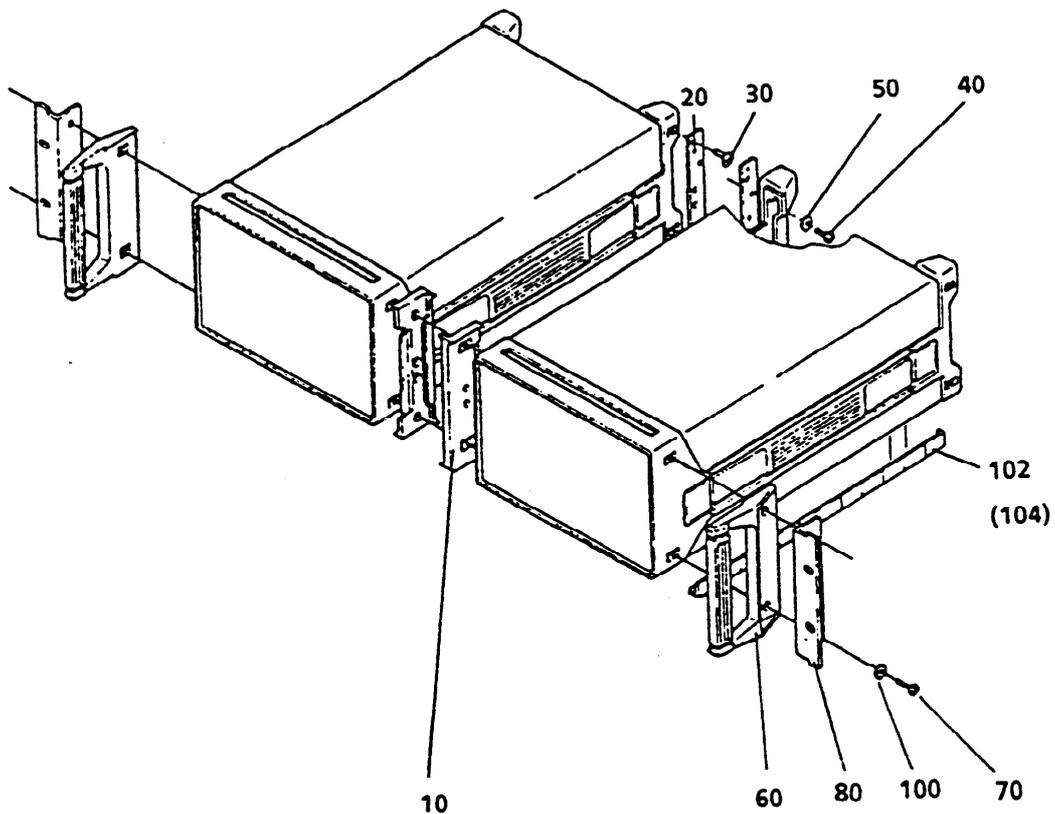
Fig. 2.4 Parts Set R&S KA 890L1
