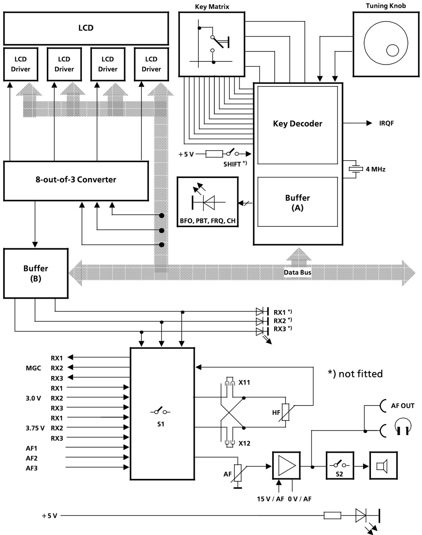
Fig. 1.7 Control Unit (R&S EK 896), Block Diagram
