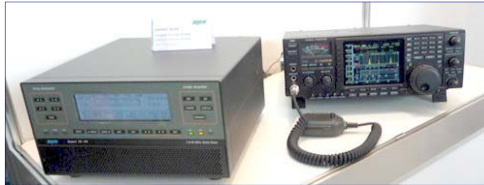
SPE 1K-FA 1 kW MOSFET amplifier
