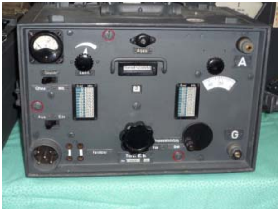
--- • • • --- • • • • • • • • • • Torn.E.b HF TRF receiver (0.1 – 6.7 MHz)
