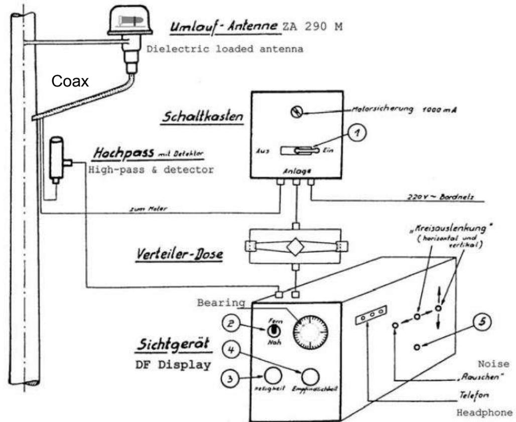
Gesamtanlage Fu MB 28 (Naxos ZM 4) (System diagram)
